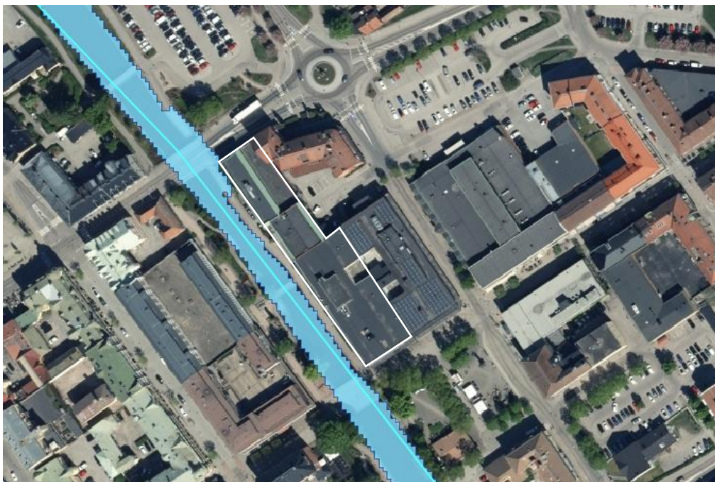
Figur 7. Översvämningsskarta från MSBs översvämningsskartering av Köpingsån. Kartan visar ett 200-årsflöde med klimatanpassning.
